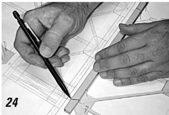
Fig. 13 – Montarea tuturor fășiilor (elementelor întinse) pe o singură parte a grinzii
