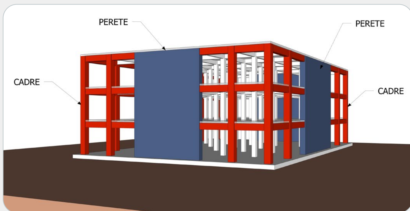
Fig. 5.7 – Schemă de principiu - Structuri duale
