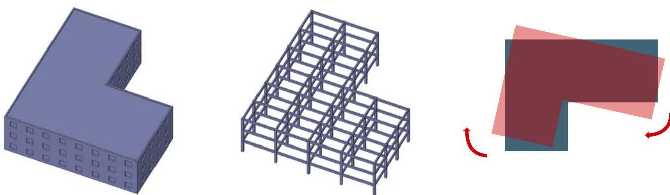
Fig. 6.3 – Clădire sensibilă la torsiune și urmări posibile ale torsionării clădirii.
