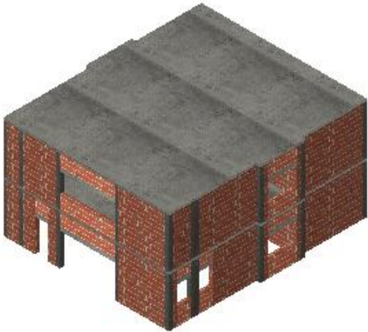
Vedere 3D a structurii de zidărie P+1E.
